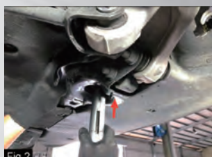
Fig 2 • Insira o corpo da ferramenta principal na mola
