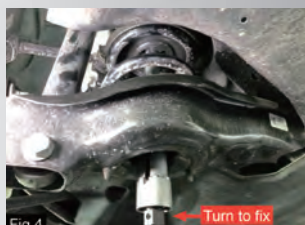
Fig 4 • Gire a porca sextavada na extremidade inferior do corpo da ferramenta principal para fixar todas as peças
