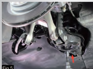
Fig 5 • Use uma chave de ar/impacto para comprimir a mola
