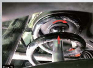
Fig 3 • Insira através do disco e gire meia volta para conectar a ferramenta e o disco
