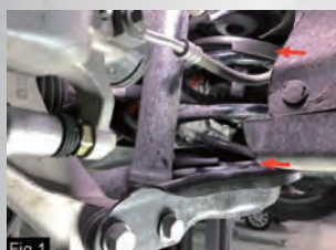
Fig 1 • Coloque os discos superior e inferior na mola
